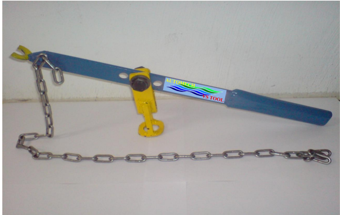
RAJAH 11 : GAMBAR VALVE SEAL TOOL SELEPAS INOVASI
